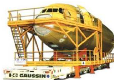
Ateliers d'Aérospatiale à Saint-Nazaire : Véhicule capable d'optimiser les délais d'assemblage de tronçons d'Airbus
