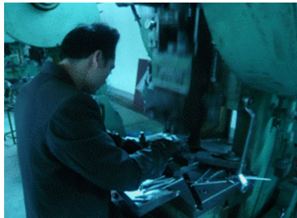
Poinçonnage de la pièce
