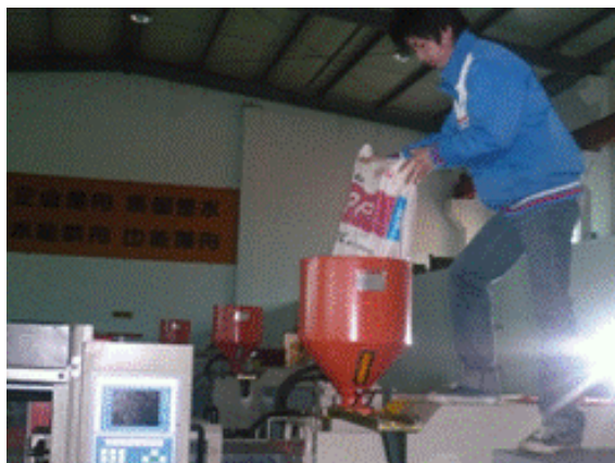
Alimentation en granulé de plastique
