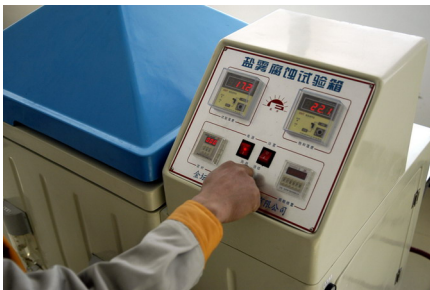
Machine de test de corrosion par jet de sel
