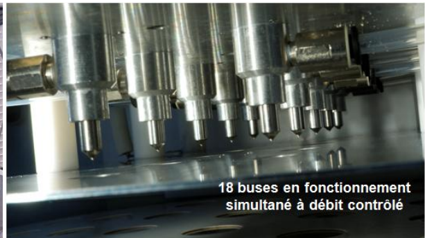
Vue de la tête de pulvérisation comportant 18 buses fonctionnant simultanément
