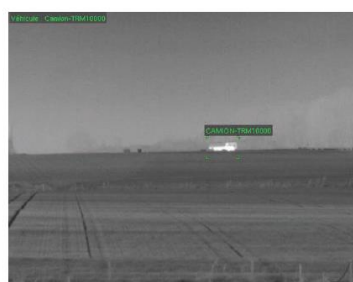
Exemple de détection, reconnaissance et identification sur image infrarouge réelle
