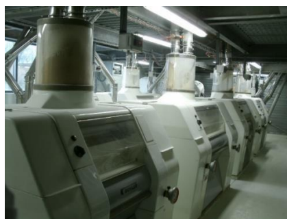
Broyage du blé sur cylindre
