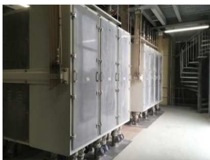
Blutage sur plansichter (Séparation du son et de la farine)
